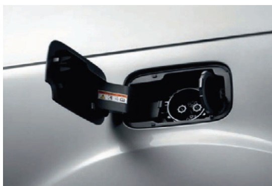
Zásuvka pro rychlodobíjení (umístěna nad zadním kolem)
